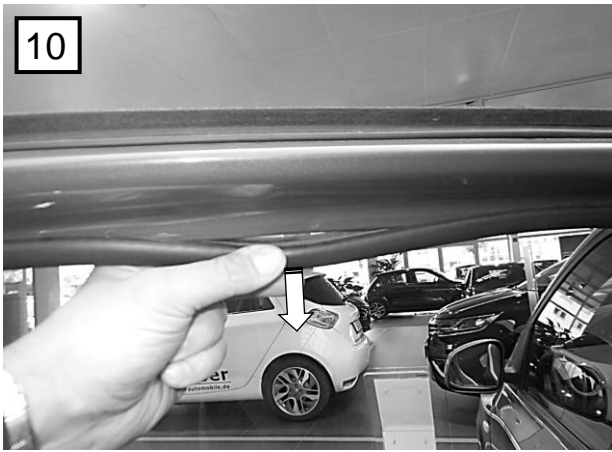
10 Fenstergummi abziehen / remove the window rubber
