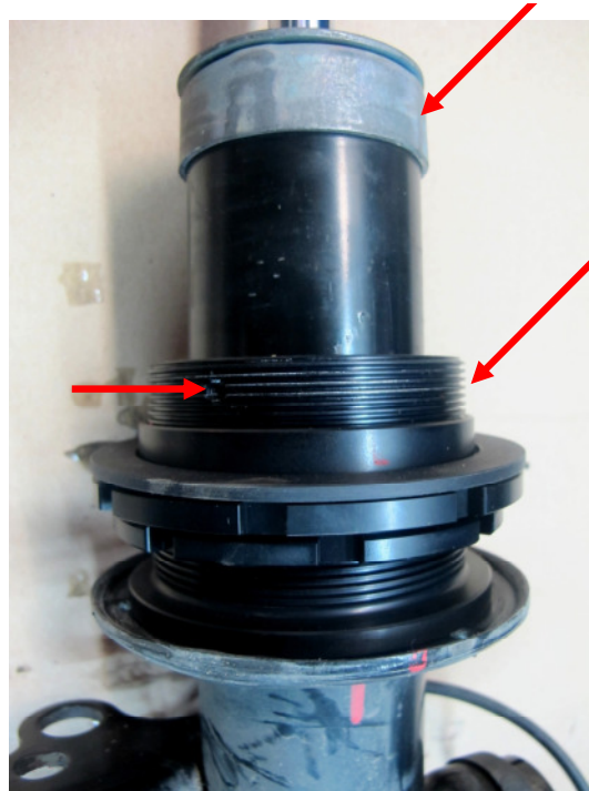
Abb. 2: Höhenverstellung und Abdeckkappe mont. Fig. 2: Mount the height adjuster and cap
