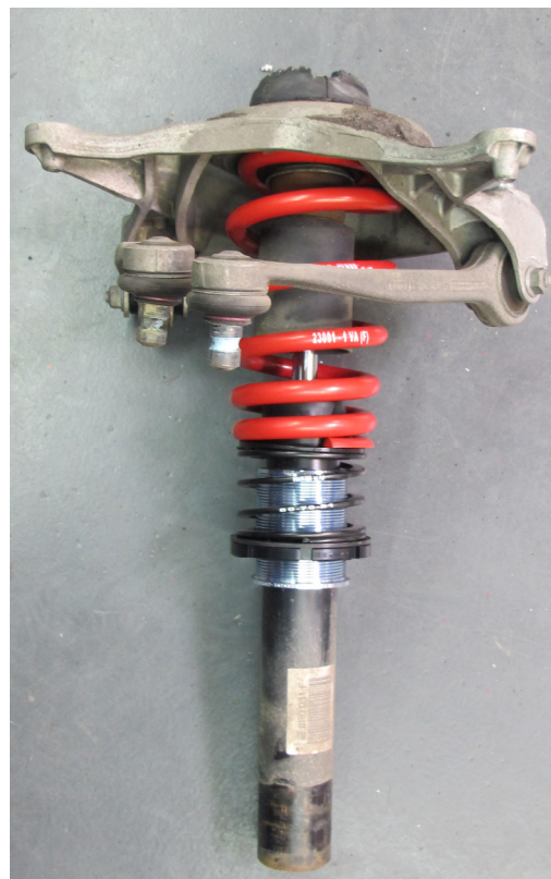
Abb. 3: Feder-Dämpfer-Einheit komplett Fig. 3: Complete spring-damper-unit
