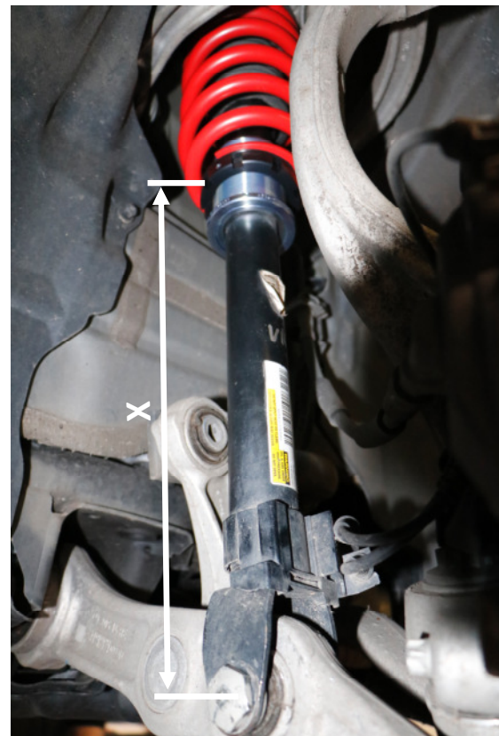
Abb. 4: Einstellmaß X VA (Abbildung ähnlich) Fig. 4: Adjustment dimension X FA (Fig. may vary)
