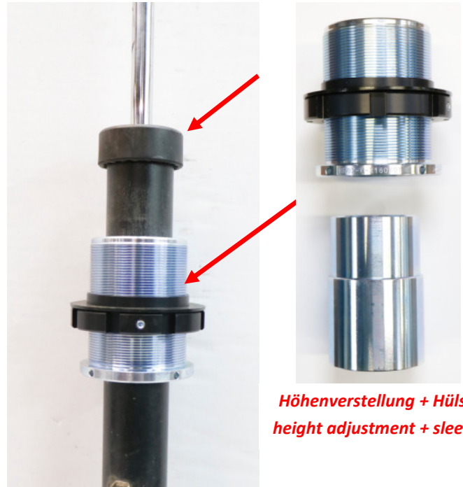
Abb. 2: Höhenverstellung und Abdeckkappe mont. Fig. 2: Mount the height adjustment and cap
