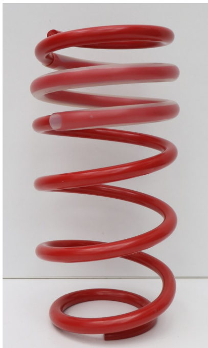
Fahrerseite: das untere Federende zeigt zum Fahrzeugheck Left side: the lower spring end points to the vehicle rear
