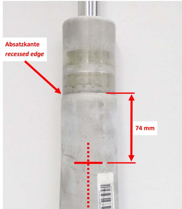
Abb. 2: Position der Höhenverstellung markieren Fig. 2: Mark the position of the height adjuster
