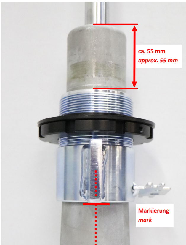
Abb. 3: Höhenverstellung aufpressen Fig. 3: Press the height adjuster on the damper
