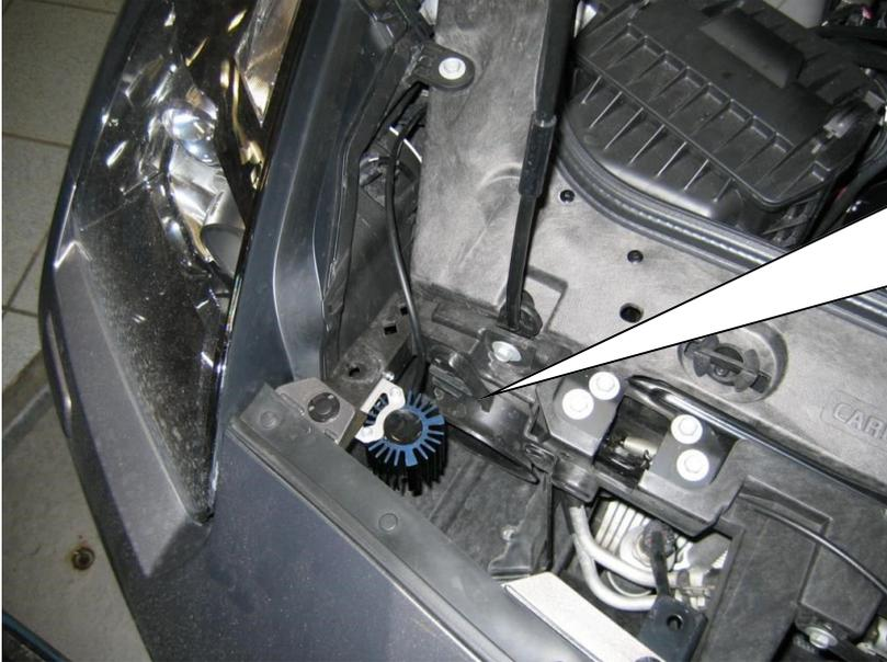
Die Stilllegungen und Halterungen werden mit den mitgelieferten Blehschrauben am Fahrzeug montiert.
