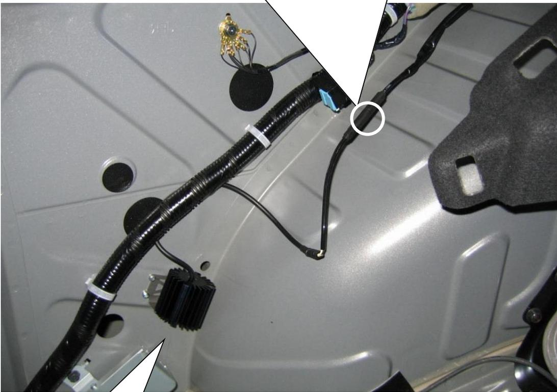
Die Stilllegungen und Halterungen werden mit den mitgelieferten Blechschrauben am Fahrzeug montiert.
