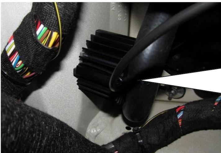
Die Stilllegungen werden, wie in der Abbildung zu sehen, auf den Fahrzeugrahmen geklebt. Anschließend wird die originale Dämpfersteuerungsleitung in die Stilllegungen eingesteckt. Es ist zwingend auf die korrekte Verriegelung des Steckers zu achten!
