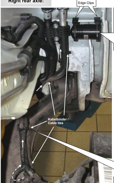
Die originale Dämpfersteuerungsleitung muss in den mitgelieferten Elektroniksatz eingesteckt werden. Achten Sie auf eine korrekte Verriegelung des Steckers und befestigen Sie diesen mit den mitgelieferten Klammern und Kabelbindern an der Fahrzeugkarosserie.
