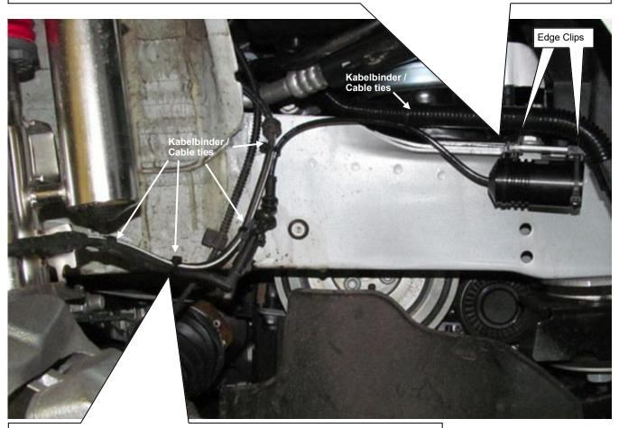
Die originale Dämpfersteuerungsleitung muss mit den mitgelieferten Kabelbindern befestigt werden.
