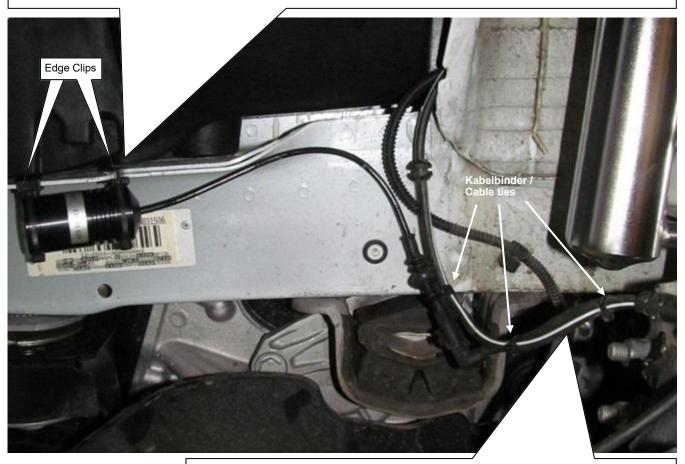
Die originale Dämpfersteuerungsleitung muss mit den mitgelieferten Kabelbindern befestigt werden. Fix the OEM damper control wire with cable ties.
