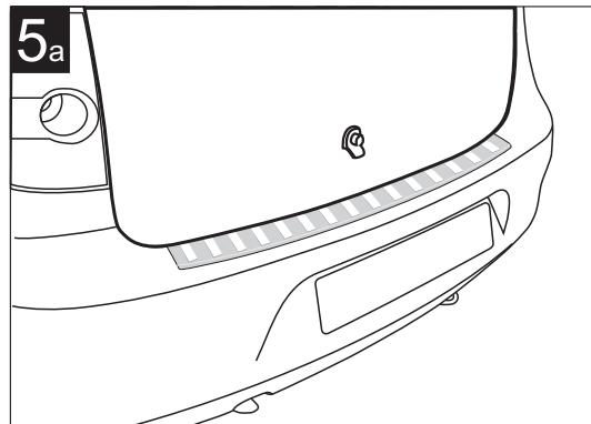
**(PL)** UWAGA !!! Naklejenie listwy na wcześniej nawoskowaną, źle odtłuszczoną nawierzchnię spowoduje nie trzymanie się warstwy klejowej, co może bezpośrednio doprowadzić do uszkodzenia klapy bagażnika. Producent w takim przypadku nie będzie ponosił odpowiedzialności za uszkodzenia powstałe wskutek wadliwego montażu.
