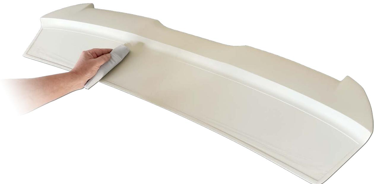
**Kleber auf der Klebefläche des Spoilers auftragen. WICHTIG: Der Kleber ist so aufzutragen, dass keine Luft eingeschlossen wird! Zum Beispiel keine geschlossenen Kreise mit dem Kleber ziehen.**
