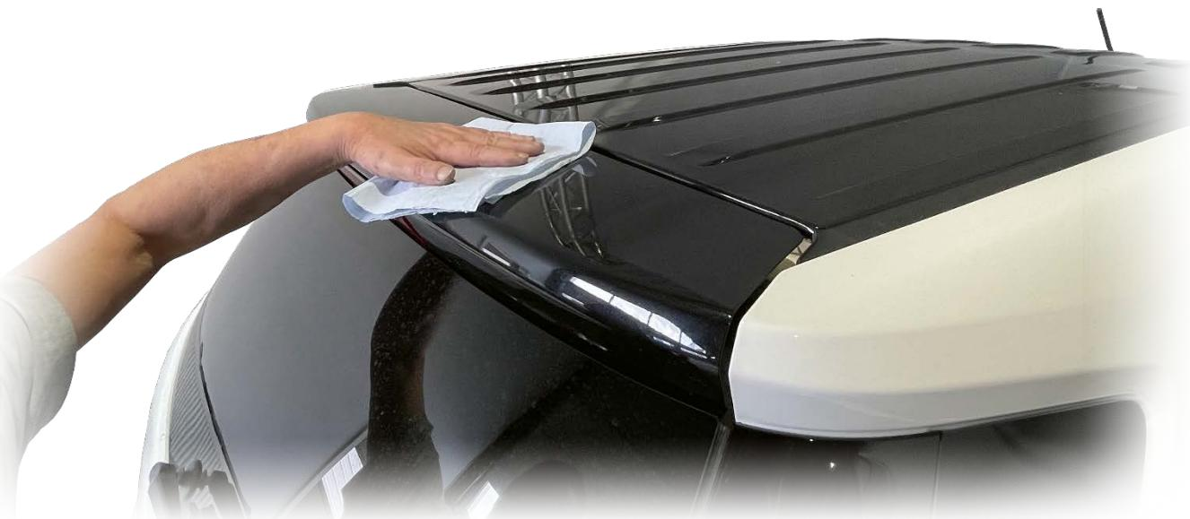
**Klebeflächen am Spoiler mit Schmirgelpapier anrauen und anschließend mit Waschbenzin reinigen.**
