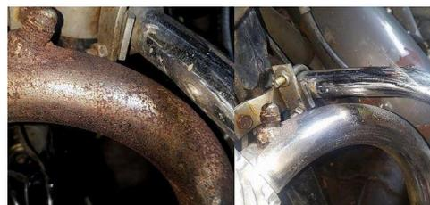
Um das glänzende Aussehen von Edelstahlkomponenten zu erhalten, sollten diese Komponenten regelmäßig gereinigt werden. Streusalz sollte sofort von allen Teilen der Abgasanlage entfernt werden
