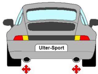
Starten Sie den Motor um den kompletten Sportaschalldämpfer auf Dichtheit zu prüfen. Prüfen Sie alle Elemente auf ordnungsgemäßen Betrieb, sowohl in einem kalten als auch im Warmen Betrieb der Abgasanlage.
